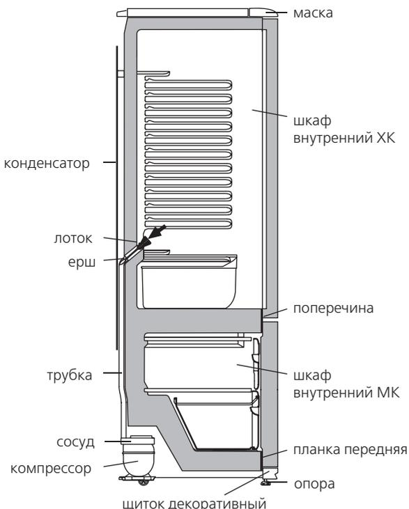
**Рисунок 12** — Схема слива талой воды из ХК
